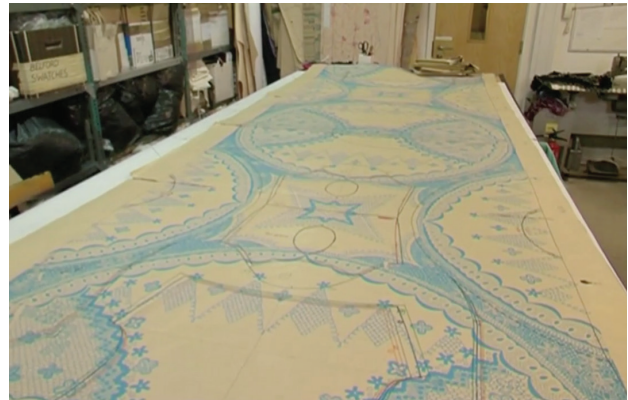
Рис. 12 – Розположення текстильного принту та деталей крою костюму. Фото з відео-туторіалу виготовлення колекції «The Knitted Circle collection»
