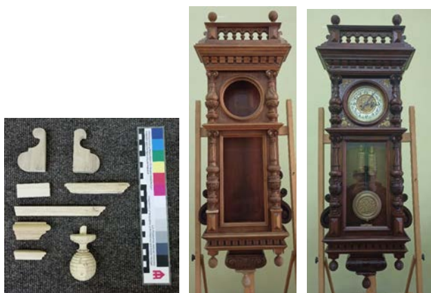
а) б) в) Рис. 4. Вигляд твору на етапі доповнення втрачених деталей: а) реставраційні вставки виготовлені з деревини дубу; б) корпус годинника після закріплення реставраційних вставок на відповідні місця; в) корпус годинника після проведення реставрації (Фото автора)
