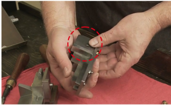
Лл. 8. Кадри з Youtube, каналу OutofSortsFilm, де представлено процес збору словолитної машини. На зображенні обведено реєстр, який майстер закріплює до найдовшої деталі, прикметно, що отвір для кріплення має ширшу форму для можливості руху реєстрів в майбутньому
