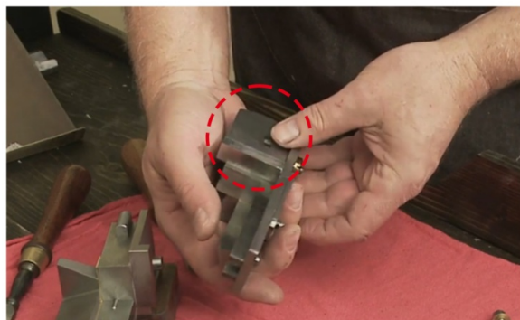
Іл. 8. Кадри з Youtube, каналу OutofSortsFilm, де представлено процес збору словолитної машини. На зображенні обведено реєстр, який майстер закріплює до найдовшої деталі, прикметно, що отвір для кріплення має ширшу форму для можливості руху реєстрів в майбутньому
