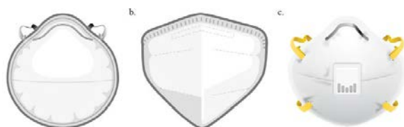
Рис. 15. Різні форми респіраторів FFP2 з фільтруючою маскою: а) тип моделі чашка; б) тип складної моделі; с) тип моделі-вкладиша [9]
