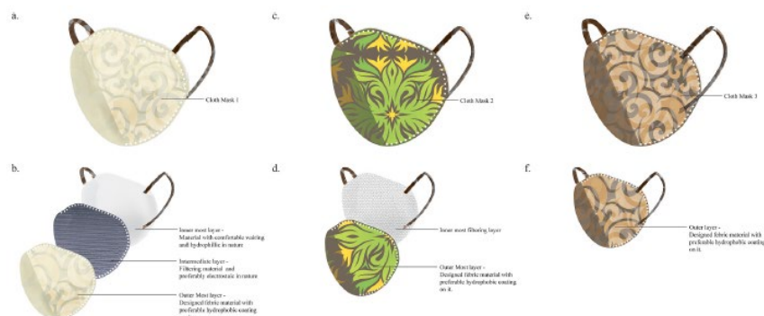
Рис. 10. Різні типи тканинних масок і їх шарування: а) тканинна маска; б) різний візерунок шарування тканинної маски; с) тканинна маска; d) різний візерунок шарування Cloth Mask; е) тканинна маска; f) різний візерунок шарування Cloth Mask [9]
